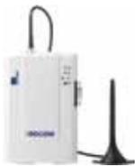
**GSM500.4G – LTE/UMTS/GSM Gateway** mit POTS Leitung und seriellen RS232/RS485/CANBus Datenanschluß. Komplett mit Netzgerät, Akku und Antenne.
